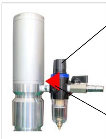
Потяните наверх рукоятку регулятора давления, вращая ее по часовой стрелке, чтобы увеличить давление, и против часовой стрелки, чтобы уменьшить давление.
